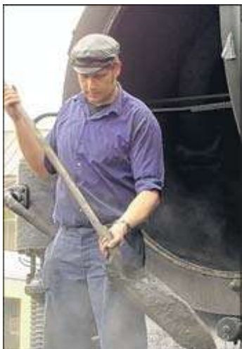
Sebastian Pense entfernt den angefallenen Ruß aus der Rauchkammer.
